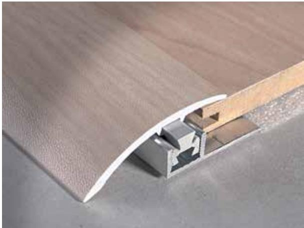
Patentiertes Abschlussprofil zur Überbrückung von Unebenheiten zwischen 0 und 6mm. Die Elemente, aus denen das System MULTICLIP besteht, können mit dem Kunststoff-Clip perfekt miteinander verbunden werden und verleihen dem System hohe Belastbarkeit, Regulierbarkeit und Flexibilität. Durch die leichte Drehung des Abschlussprofils passt sich das Profil perfekt an den Höhenunterschied an, der ausgeglichen werden soll.
